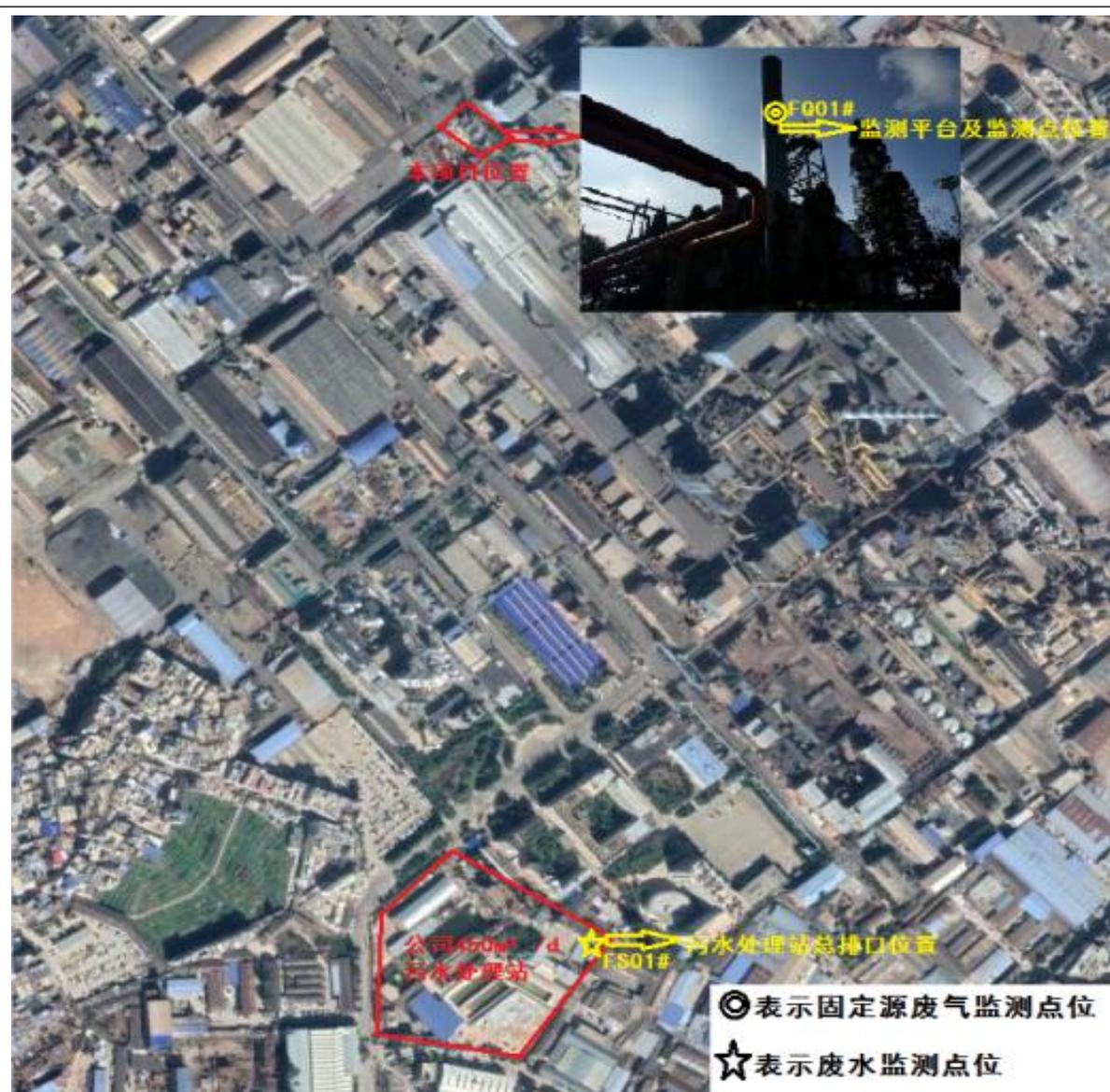
图 5.2 有组织废气及废水监测点位布设图
